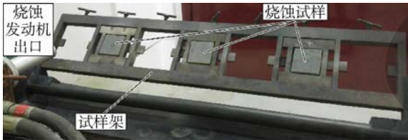
图 2 试样安装图 Fig. 2 Installation diagram of samples
